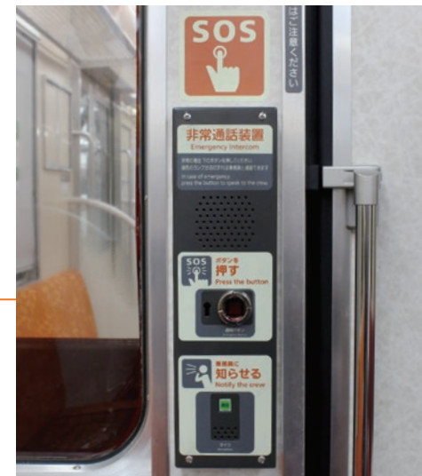
▲非常通話装置
